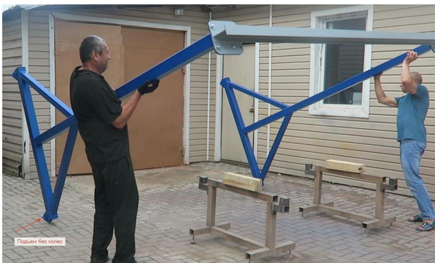
Малогабаритные краны возможно поднять в вертикальное положение вручную. В этом случае колеса устанавливаются после подъема крана в вертикальное положение.
