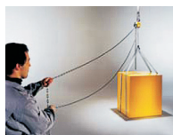
Управлять подъемом груза можно на расстоянии от него
